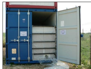
Kontajner s inštalovaným flexi-tankom
