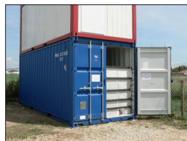
Kontajner s naplneným flexi-tankom
